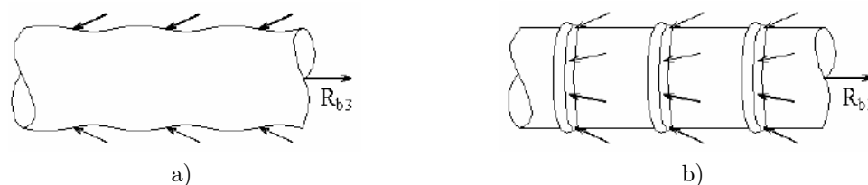
Figura 9 - Aderência mecânica: a) Armadura lisa; b) armadura nervurada (Fernandes e Debs 2005).
