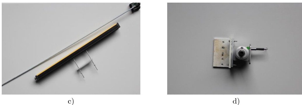
Figura 32 - Sensores utilizados: a) Potenciômetros (da GEFRAN); b) LVDTs (da APPLIED MEASUREMENTS LTD); c) Transdutores lineares (Barras TURCK); d) Transdutores de fio.
