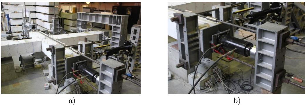
Figura 28 - a) Sistema auto-equilibrado adotado; b) Atuador hidráulico utilizado para aplicação do esforço axial.
