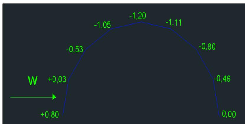
Figura A 10: Coeficientes de pressão exterior de um arco representativo dos pórticos centrais da estrutura.
