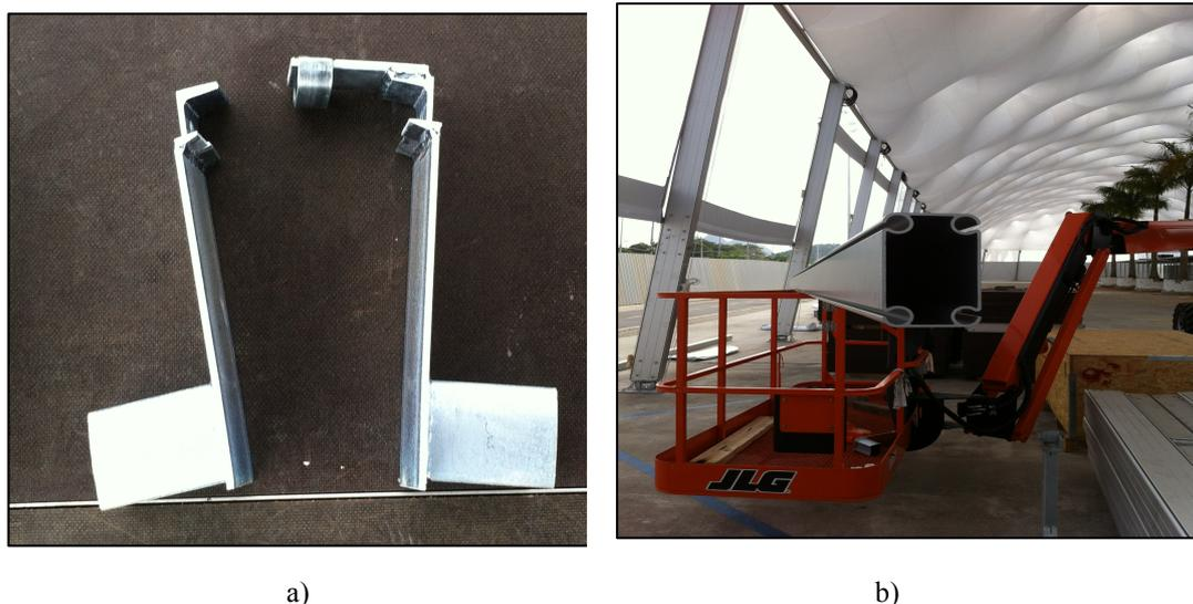
Figura 65: Agarras fabricadas para fixação das cortineiras aos pórticos. b) Barras com design fabricado para segurar as cortineiras e permitir a sua aplicação.
