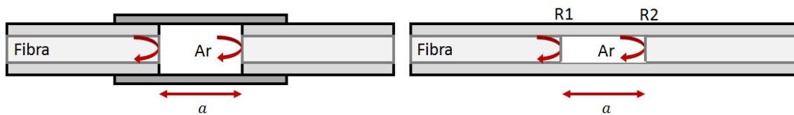
Figura 2.2: Esquema de um sensor FPI (a) extrínseco e (b) intrínseco, onde a designa a largura da cavidade e R_1 e R_2 as superfícies refletoras da fibra e da cavidade, respetivamente. Adaptado de [10].
