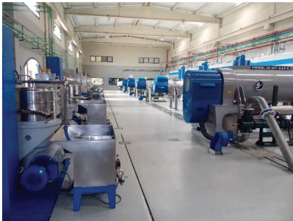
Figure 7. Two-phase decanters in series in an olive mill for the extraction of olive oil (Picualia, Proyecto de traslado y perfeccionamiento de almazaras por fusión de Cooperativas 'Agrícola de Bailén virgen de Zocueca', Jaen, Spain) (Source: Marco Nuti).
