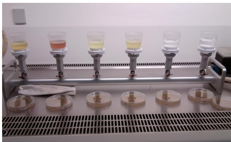
Figura 5: Rampa de filtração montada com os respetivos copos de filtração descartáveis, com os diferentes grupos de tratamento.
