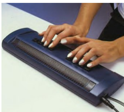
Figura 39 – Exemplo de um conversor de Braille (Abledata, 2001)
