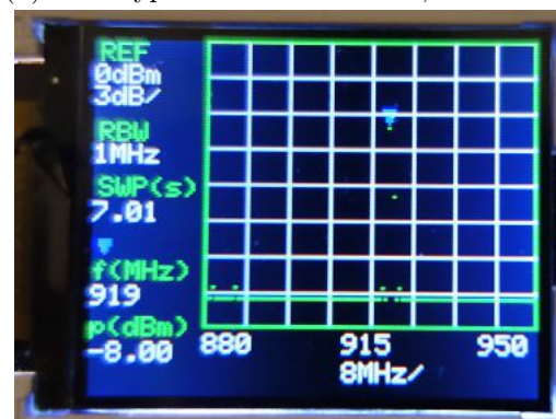
(d) Prototype readout: 919 MHz, -8 dBm
