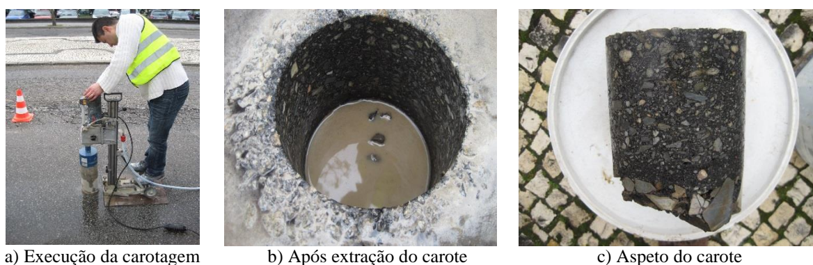
Figura 50: Carote extraído no sentido Sul-Norte da Avenida da Universidade (fotografias de autor)
