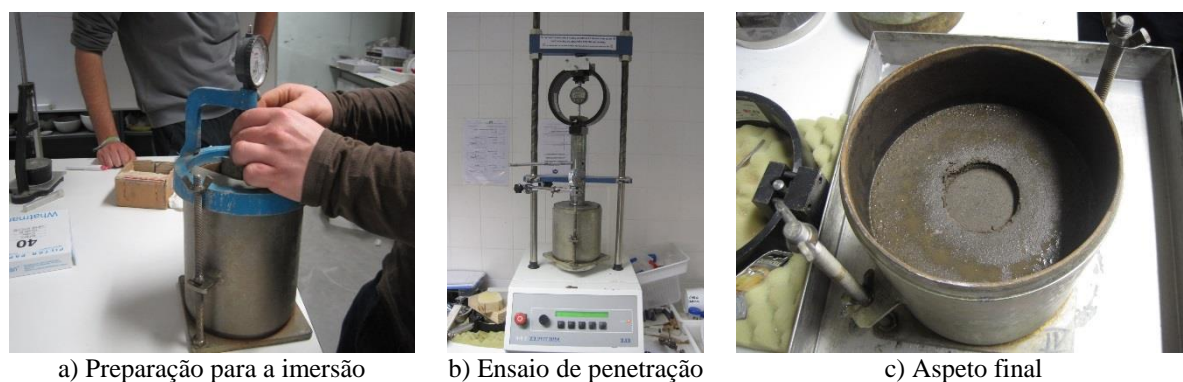
Figura 60: Procedimento do ensaio de CBR (fotografias de autor)
