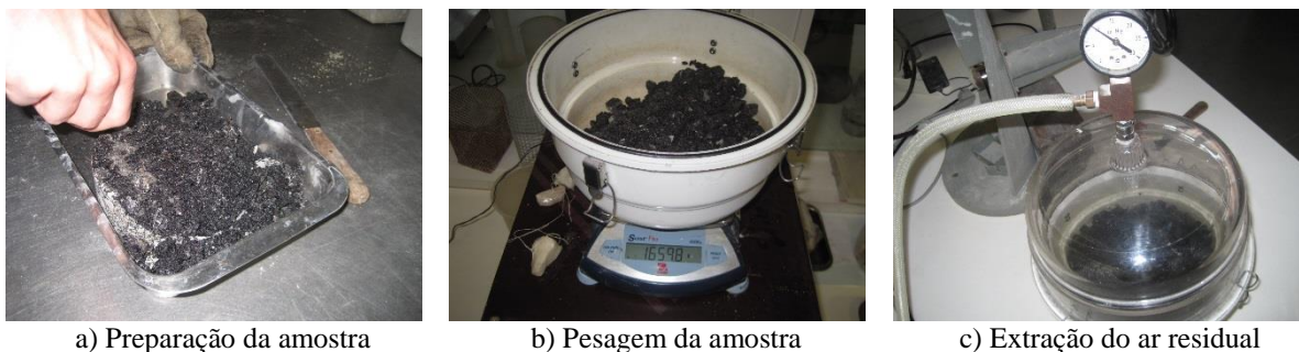
Figura 62: Procedimento do ensaio de baridade máxima teórica (fotografias de autor)
