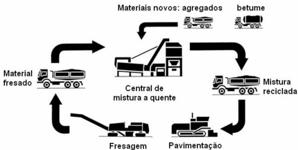
Figura 38: Esquema do processo de reciclagem a quente em central (Baptista, 2006)
