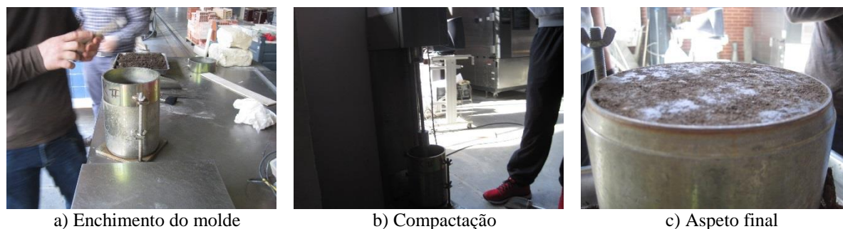
Figura 59: Procedimento do ensaio Proctor (fotografias de autor)
