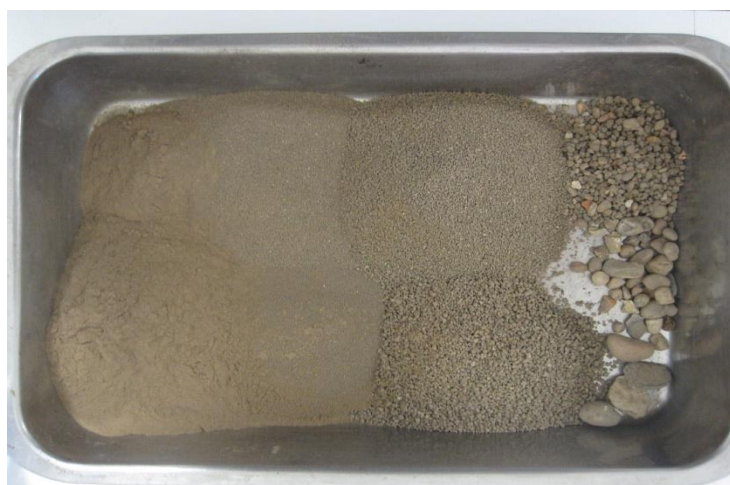
a) Aspetto do solo de fundação após peneiração
