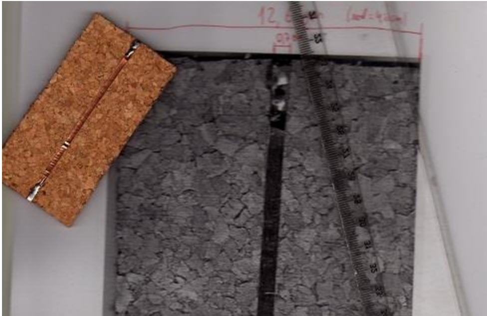
Figura 73 - Medição do W numa linha microstrip
