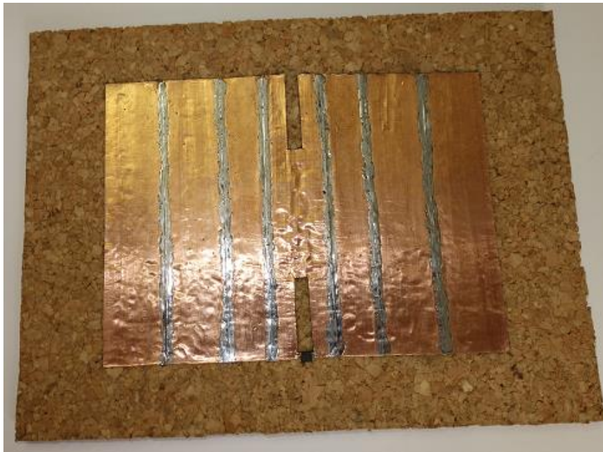
Figura 83 - Antena em H construída com cortiça e fita de cobre (plano de massa atrás)
