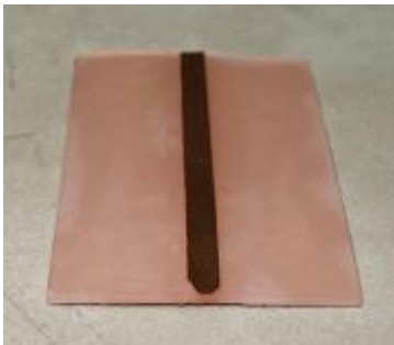
Figura 66 - Linha Microstrip em plástico
