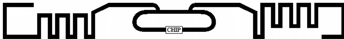
Figura 29 - Antena RFID com malha de adaptação e braços do dipolo finos [30]
