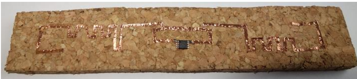
Figura 90 - Antena RFID típica construída com cortiça e fita de cobre
