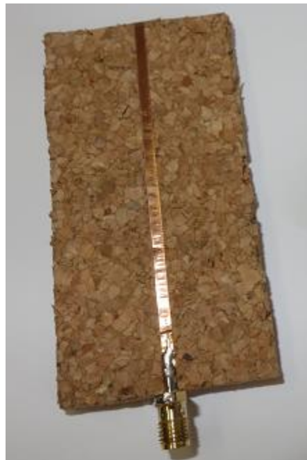
Figura 72 - Linha Microstrip mais larga em cortiça prensada
