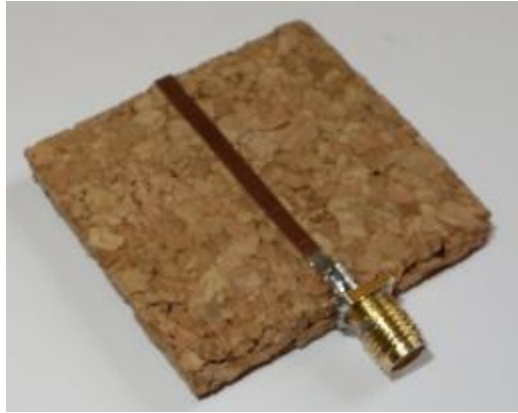
Figura 65 - Linha Microstrip em cortiça
