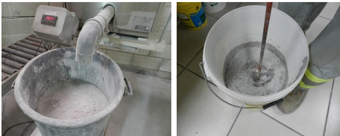
Figura 15 – Mistura dos materiais constituintes da argamassa (esquerda) e amassadura da argamassa com PCM através da misturadora (direita)
