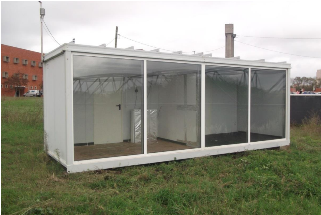
Figura 13 – Célula-de-teste instalada na Universidade de Aveiro orientada a Sul
