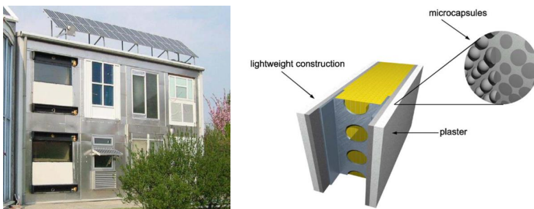
Figura 8 – Célula-de-teste da aplicação (esquerda) e incorporação de PCM nas pastas de gesso (direita) [38]
