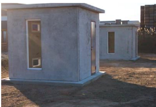
Figura 9 – Cubículos em betão com e sem PCM microencapsulado [32]
