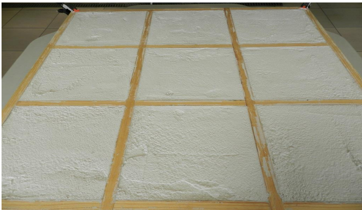
Figura 18 – Aspecto final da produção das lajetas no molde
