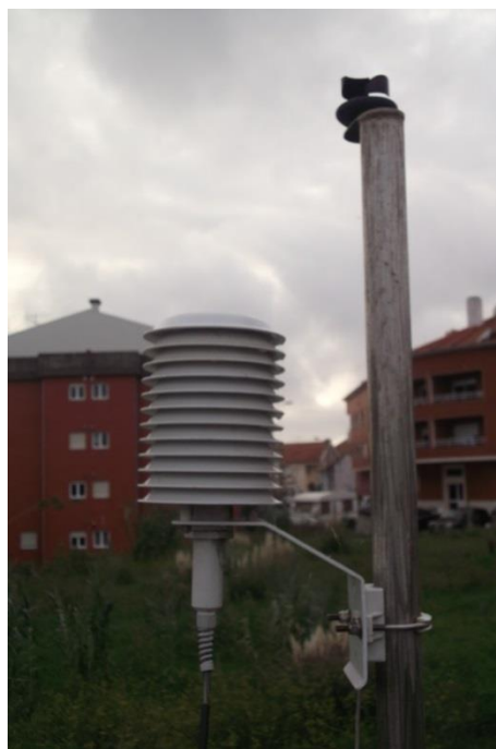
Figura 28 - Colocação da sonda HD 9008 TR numa estrutura metálica da célula de teste
