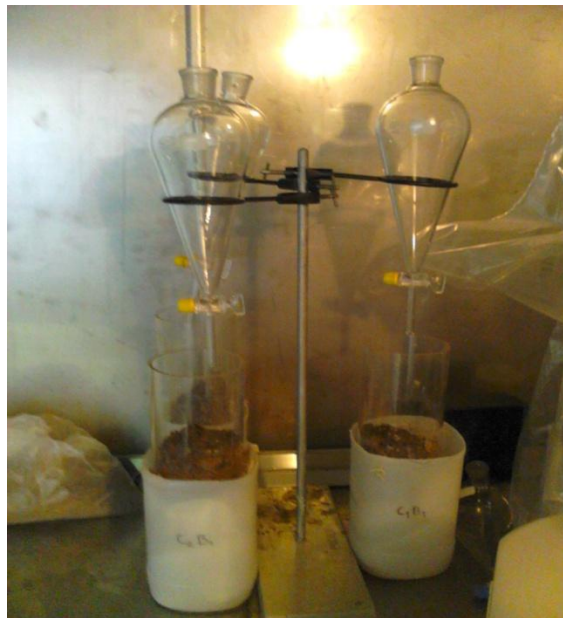
Figura 6 – Sistema de aplicação/recolha de água utilizado no ensaio de aplicação de cinza em colunas de solo.
