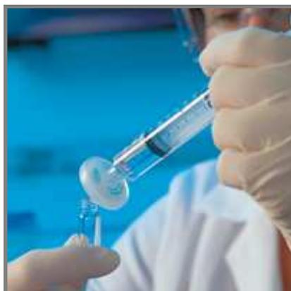
**Figura 2.21- Filtração das amostras para a cromatografia iônica.** (Fonte: <https://uk.vwr.com/>)
