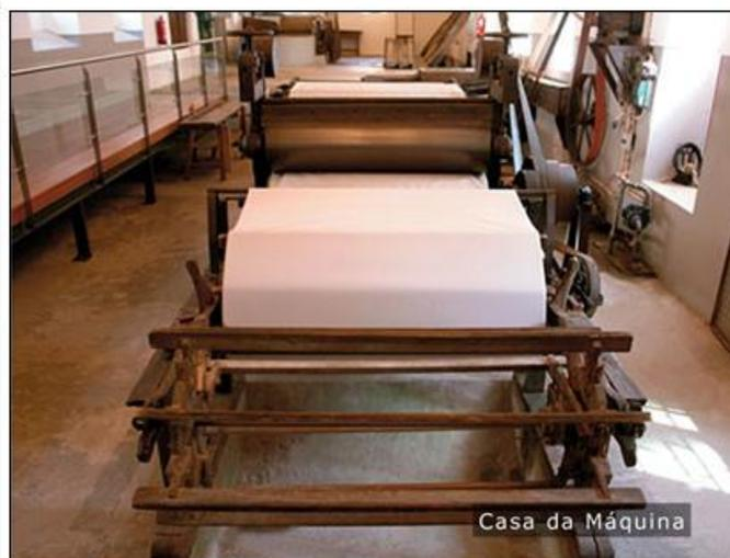
Importante também é o circuito de água inerente aos dois processos de fabrico (desde o açude, levadas e roda hidráulica), que fornece a energia hidráulica necessária para o moinho de galgas (só introduzido na indústria do papel desta região em finais do século XIX), a pila holandesa e a roda do maxão, sendo a máquina contínua accionada por energia eléctrica.
