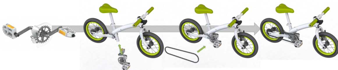
Ilustração 72 - Pedaleira e sistema de transmissão
