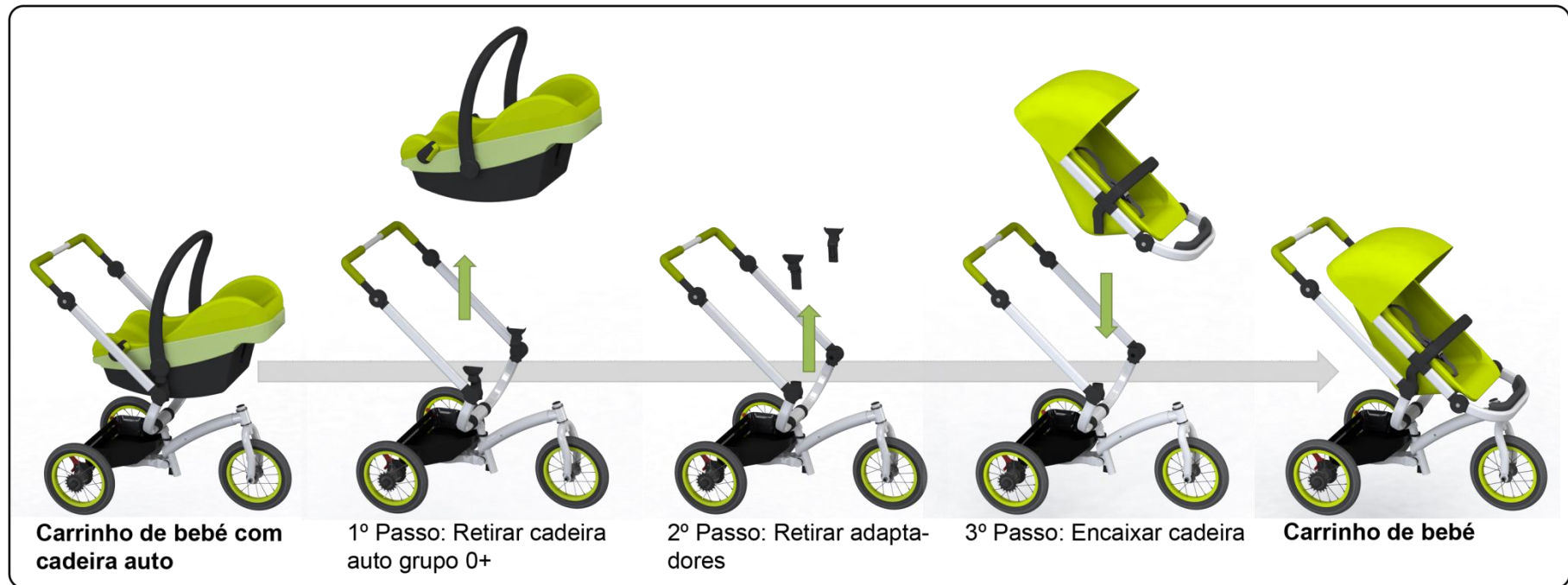
Ilustração 73 - Processo de transformação do produto (carrinho de bebé com cadeira auto para carrinho de bebé com cadeira normal)
