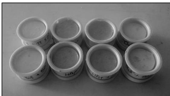
Figura 17 – Moldes cilíndricos utilizados no fabrico dos *scaffolds*.
