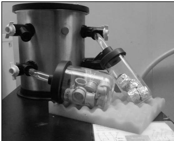
Figura 18 - Liofilizador Labconco freeze DrySystem.
