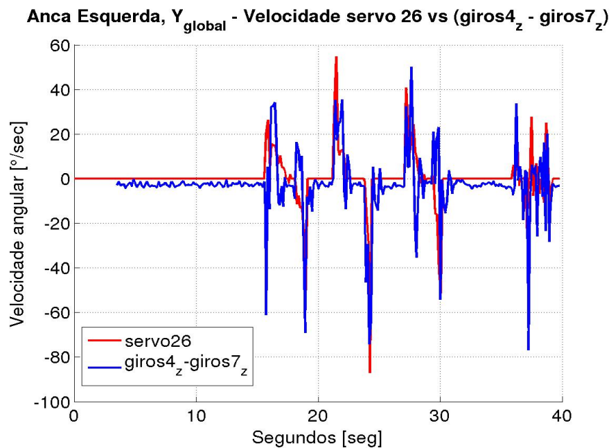
Figura 4.19: Agachamento - anca esquerda - servomotor 26 e diferença entre giroscópios de IMUs 7 e 4.
