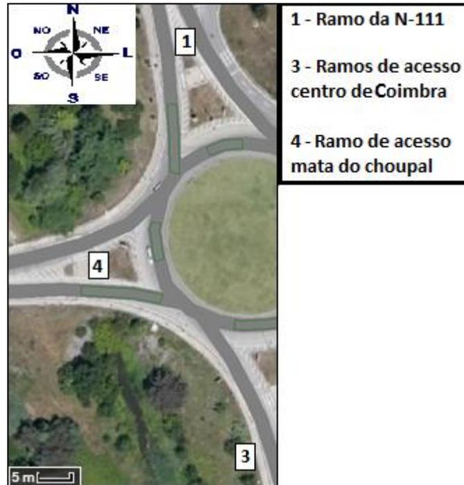
Figura 16 – Demonstração de exemplos da colocação de áreas de redução de velocidade (28).
