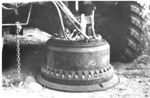
Figure 10. Surficial gasodinamical pulse source (SI-32)
