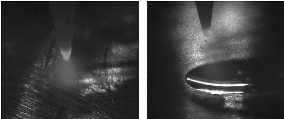
a. TIG welding on mildsteel, 124A
