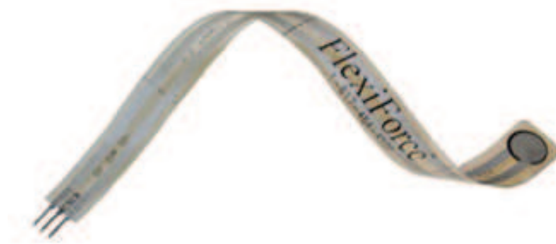
Fig. 2. Tekscan FSR sensor
