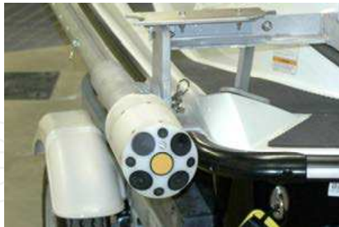
Fig. 3. SonTek/YSI RiverSurveyor M9 ADCP head.
