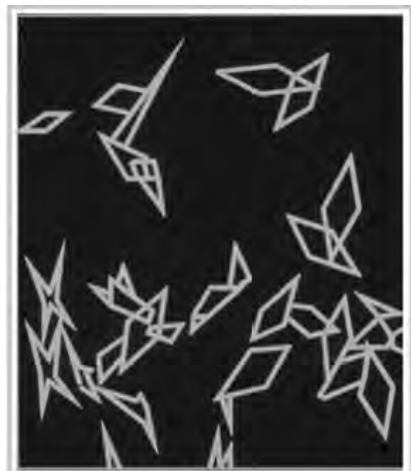
Crystal Morphology With Pour Point Depressant
