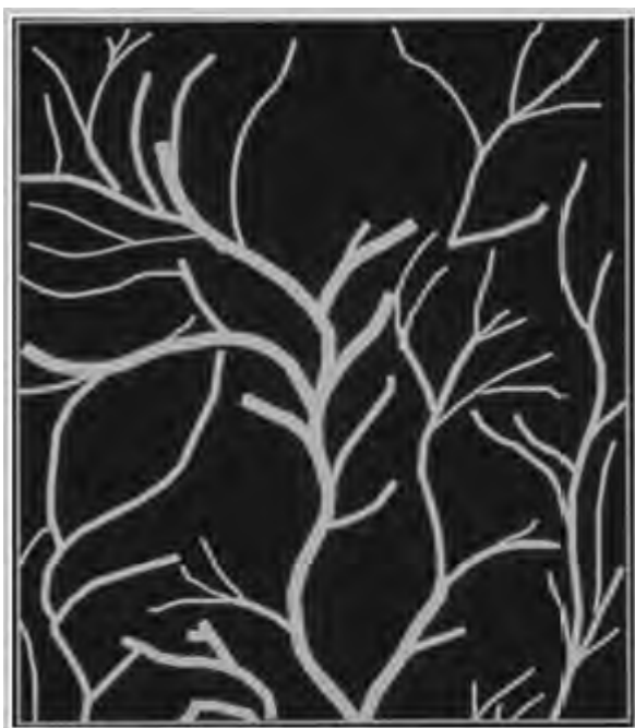
Crystal Morphology Without Pour Point Depressant
