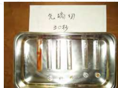
(d) Bottom edge cut tubes after 30 second washing
