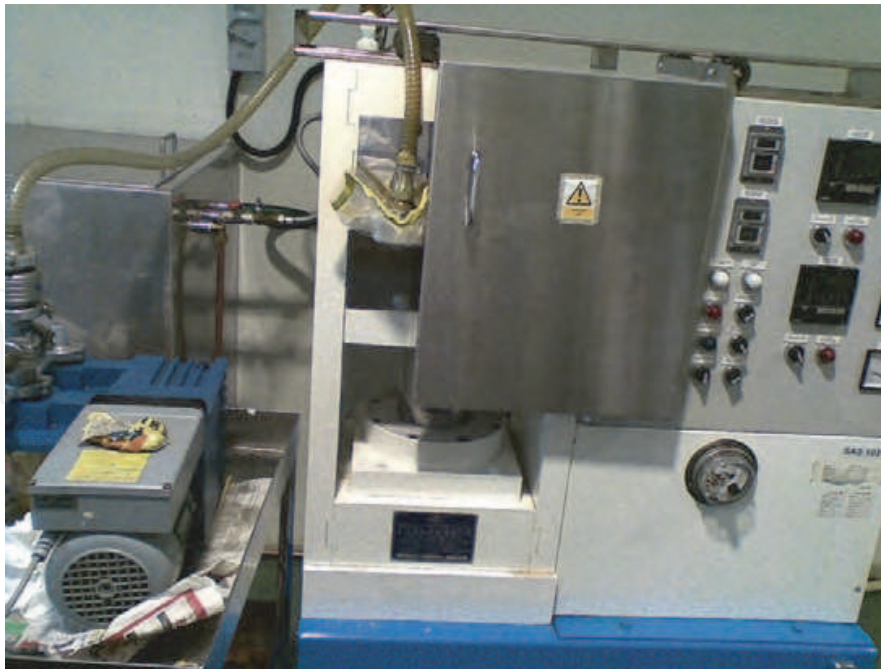
b) Actual hot press setup
