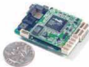
Fig. 3. Procerus Kestrel Autopilot (Beard et al., 2005).
