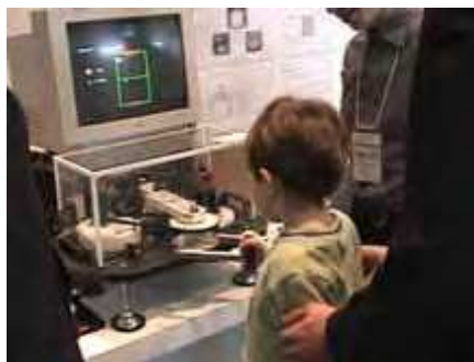
Fig. 25. Passive force display using ER brakes
