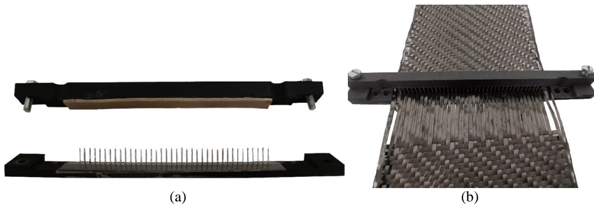
Fig. 2.30. (a) Peigne et contre peigne, (b) peigne placé sur un manche de l'échantillon
