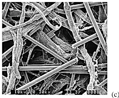
Fig. 1.4. Filage continu des fibres de verre (a), filage discontinu des fibres de verre (b), vue microscopique des fibres de verre (c) [13].
