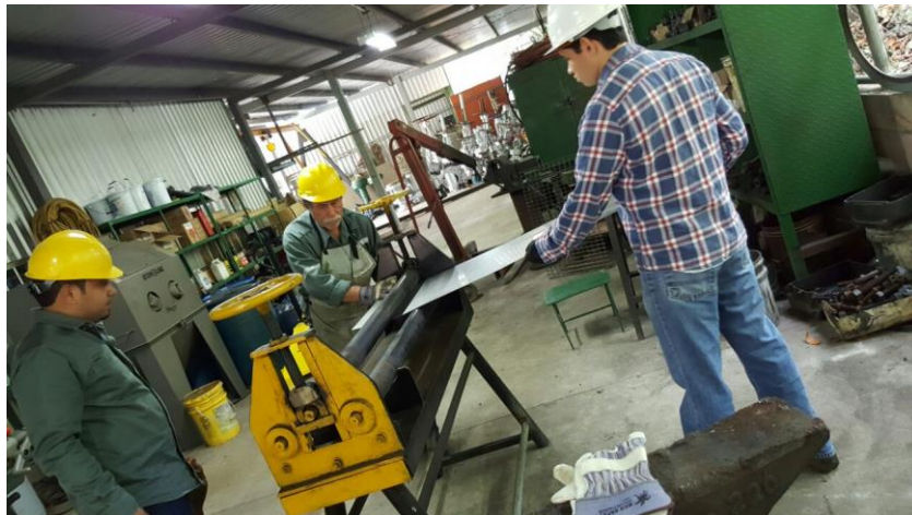
Figura 60. Rolado de las láminas de acero inoxidable AISI 304 que conformaran las cubas.
