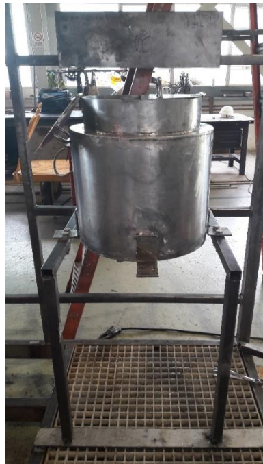
Figura 73. Elaboracion de la base de la cuba calefactora.
