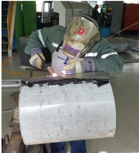
Figura 61. Cordones de soldadura por método TIG de las cubas.
