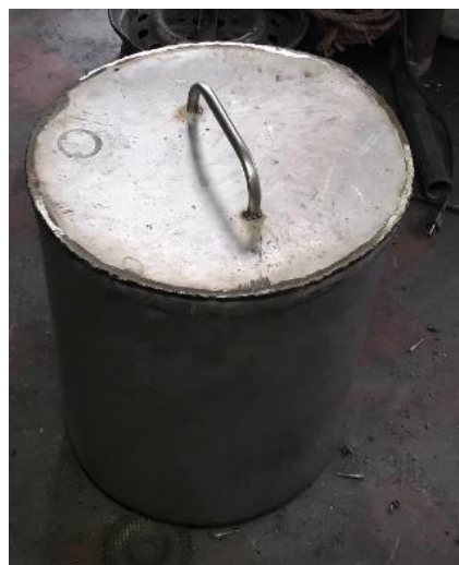
Figura 66. Finalización de la tapadera de la cuba enfriadora.
