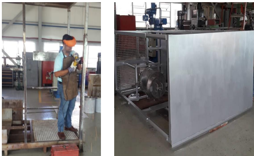
Figura 71. Esmerilado y pintado de las superficies de la estructura techada.
