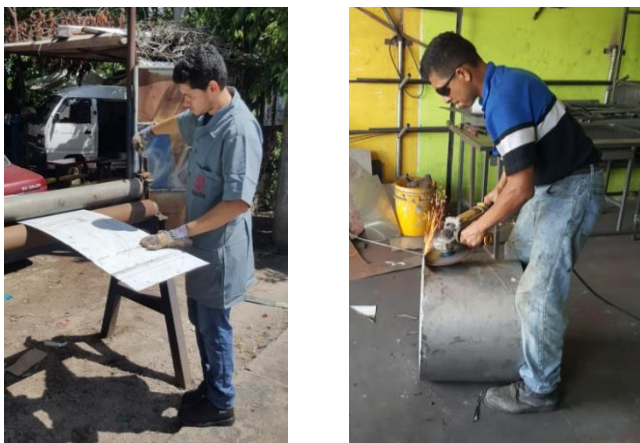
Figura 65. Rolado de la lámina que formara la chaqueta conjunto a los cortes de los anillos superiores e inferiores.
