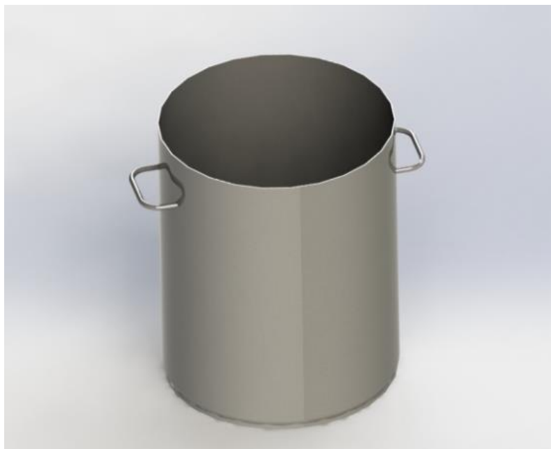
Figura 36. Cuba de enfriamiento del pasteurizador.
