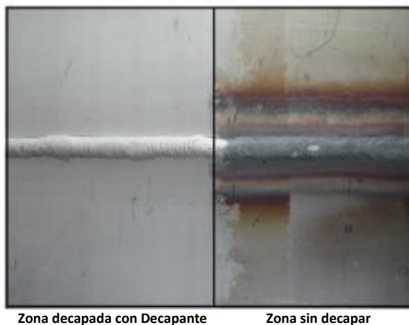
Figura 69. Aplicación de la pasta decapante en las superficies de acero inoxidable. Fuente: https://codinsa.cl/productos/accesorios/decapante-inox
