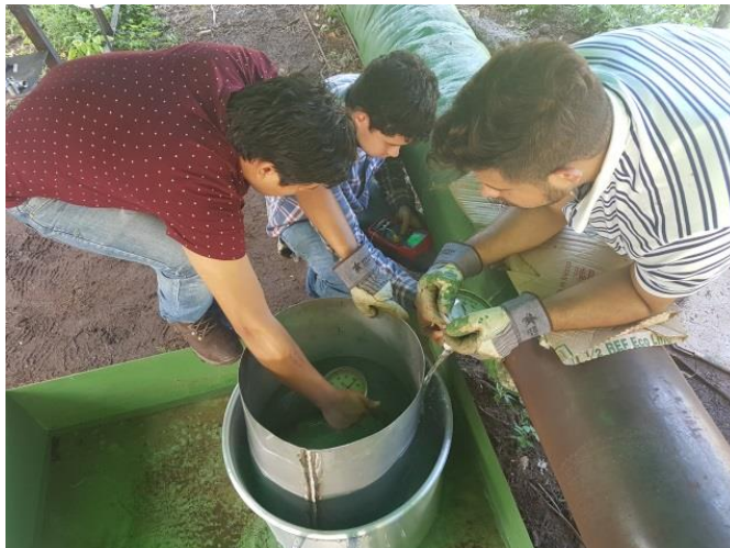
Figura 82. Toma de medición de la temperatura del agua de salida del serpentín.
