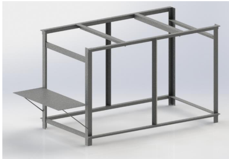
Figura 44. Base de soporte de acero A36 para el tanque de almacenamiento de agua
