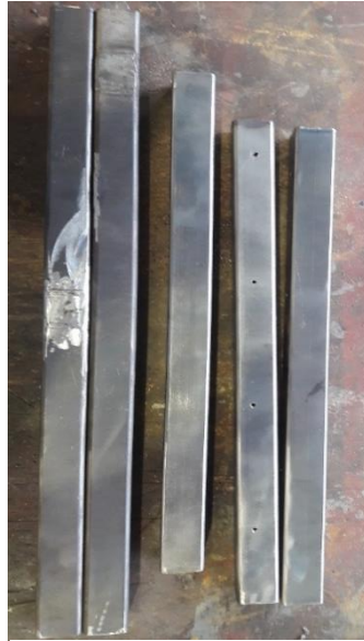
Figura 72. Proceso de esmerilado de los tubos cuadrados.
