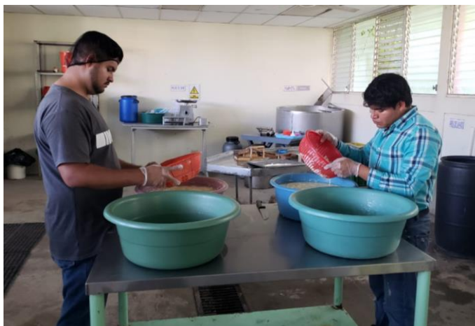
Figura 93. Proceso de desuerado con ayuda de coladores.
