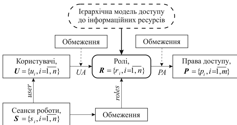
Рис. 1. Схема моделі РРД до інформаційних ресурсів системи дистанційного навчання "Віртуальний університет"
