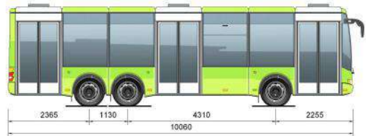
Рисунок 13 — Типорозмірний ряд міських автобусів, основний (перший) член якого містить додаткову дверну секцію (інтегральні модулі не цілком відповідають один одному)
