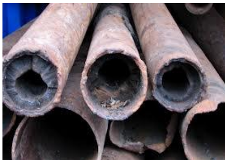
Рисунок 1 – Загальний вигляд насосно-компресорних труб нафтовидобувної промисловості, забруднених сольовими відкладеннями з умістом природних радіонуклідів
