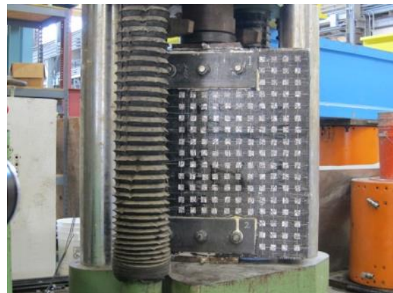
(d) Failure mode of B36-0-0-5
