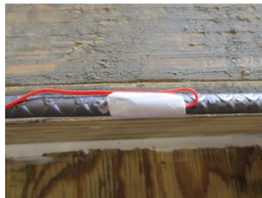
(d) Gage protection with SB tape
