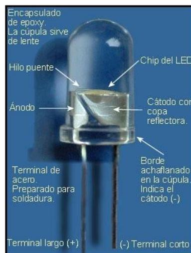
Figura N° 3: La composición de un Diodo LED <sup>5</sup>
