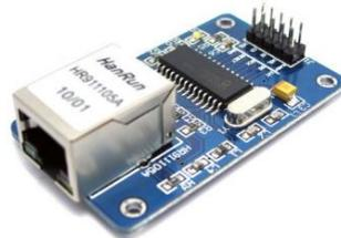
Figura N°37: Placa de Red para microcontrolador.<sup>45</sup>
