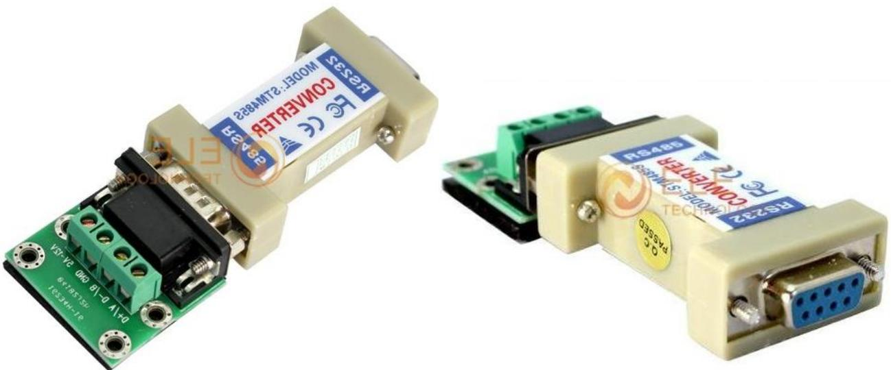
Figura N°33 Convertor RS-232/RS-485<sup>39</sup>
