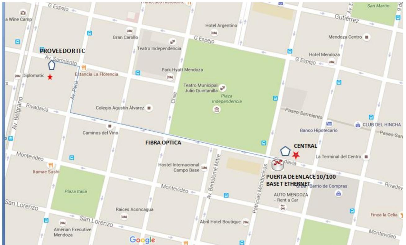
Figura N° 88: Esquema prototipo del Servicio Brindado en Mendoza.
