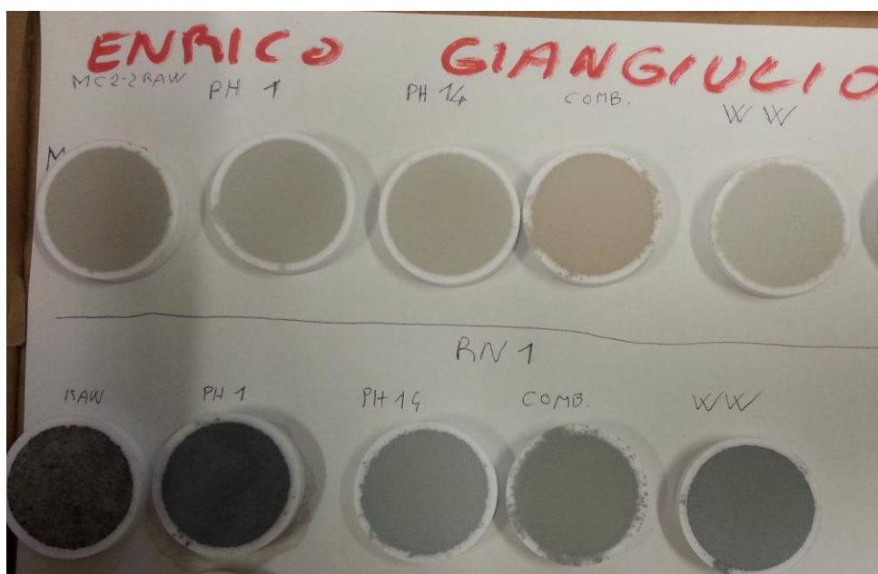
Figura 3.4: Pasticche di polvere pressata per l'analisi XRF.
