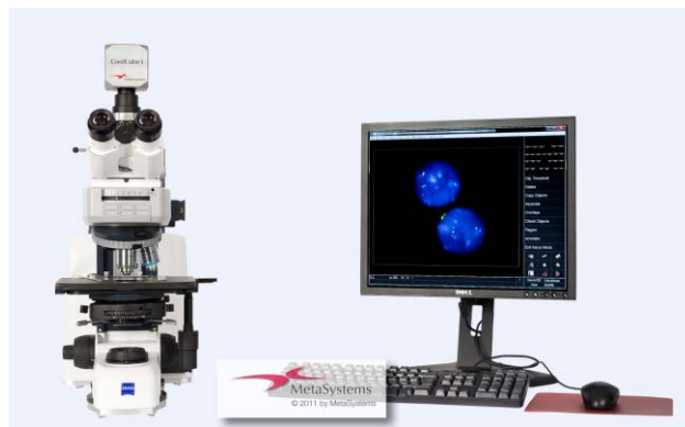
Figura 20. Microscopio Zeiss-AxioImager Z2, PC e programma di cattura di analisi di metafasi.
