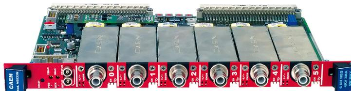
Figura 3.8. Fuente de alto voltaje CAEN V6533
