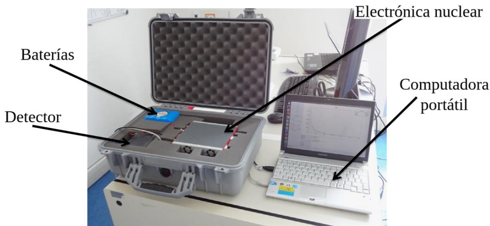
Figura 4.31. Prototipo de espectrómetro  $n/\gamma$  portátil
