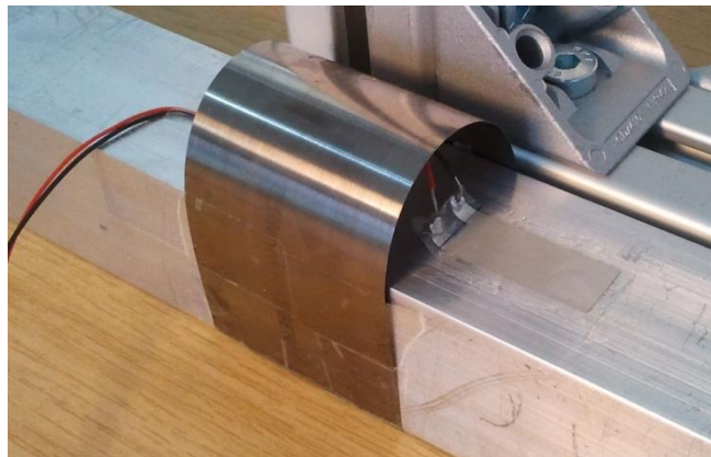
Abbildung 3-6: Demonstrator des Blocks 1 / PVDF-Folie auf Aluminiumbalken
