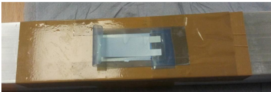
Abbildung 3-3: Foliensensor mit aufgetragenem Klebeband (blau) zum Schutz vor dem Harz
