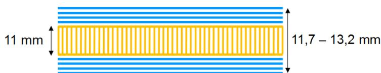
Abbildung 100: Querschnitts-Skizze Probenserie NGT 18
