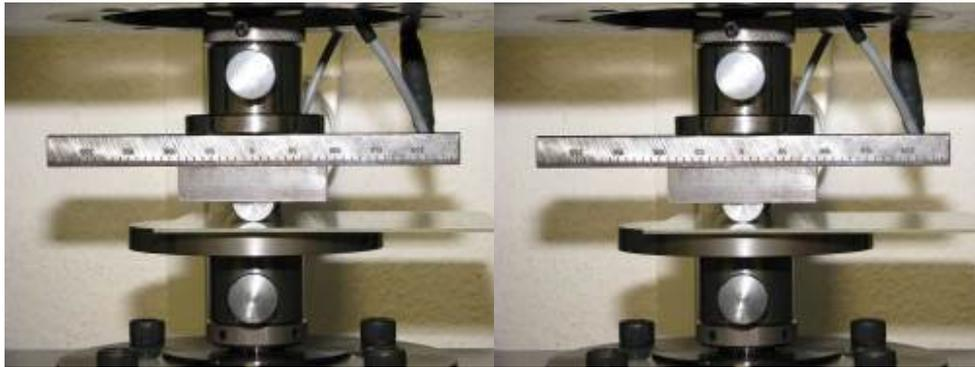
Abbildung 295: Probe NGT 40 während Prüfung mit Eindringkörper Rolle
