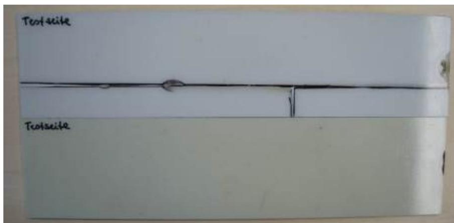
**Abbildung 343: NGT 37 und NGT 38 Draufsicht nach der Prüfung der Brandrate**
