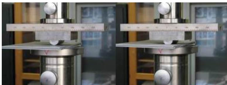
Abbildung 65: Probe NGT 4 während Prüfung mit Eindringkörper Rolle
