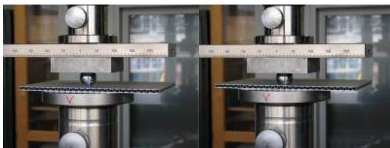
Abbildung 64: Probe NGT 4 während Prüfung mit Eindringkörper Kugel
