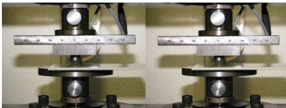
Abbildung 302: Probe NGT 41 während Prüfung mit Eindringkörper Kugel
