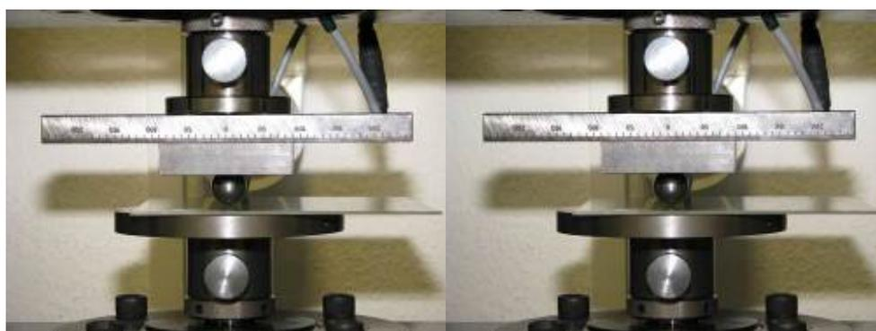
Abbildung 294: Probe NGT 40 während Prüfung mit Eindringkörper Kugel
