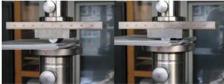
Abbildung 57: Probe NGT 3 während Prüfung mit Eindringkörper Rolle
