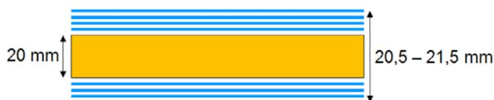
Abbildung 166: Querschnitts-Skizze Probe 24
