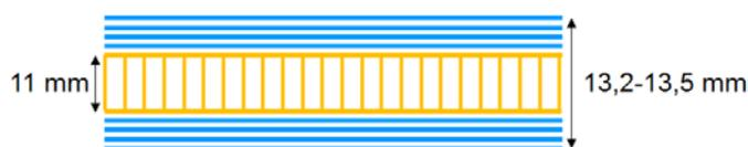
Abbildung 79: Querschnitts-Skizze Probe NGT 17
