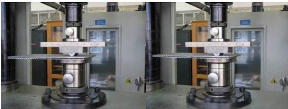
Abbildung 73: Probe NGT 5 während Prüfung mit Eindringkörper Rolle
