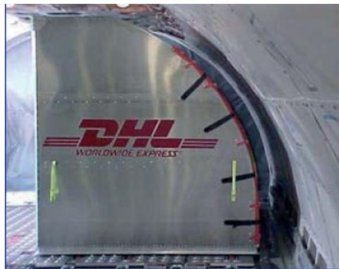
Abbildung 21: Foto des betrachteten Luftfrachtcontainers Typ AAX von der Firma Nordisk [13]
