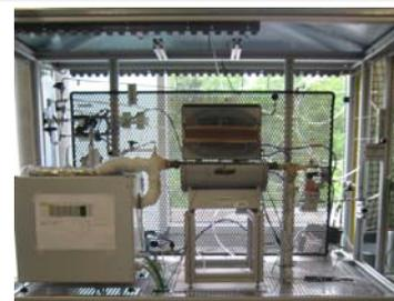
Abb. 2: Laborteststand zur experimentellen Untersuchung der Dampfreformierung von Diesel und Biodiesel
