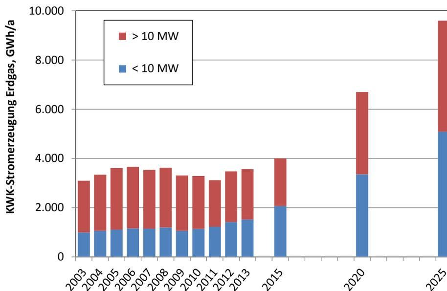
Abbildung 17: Entwicklung der KWK-Stromerzeugung aus Erdgas (einschl. Heizöl), getrennt nach Anlagen < 10 MW<sub>el</sub> und >10 MW<sub>el</sub> im aktualisierten Ausbaupfad.
