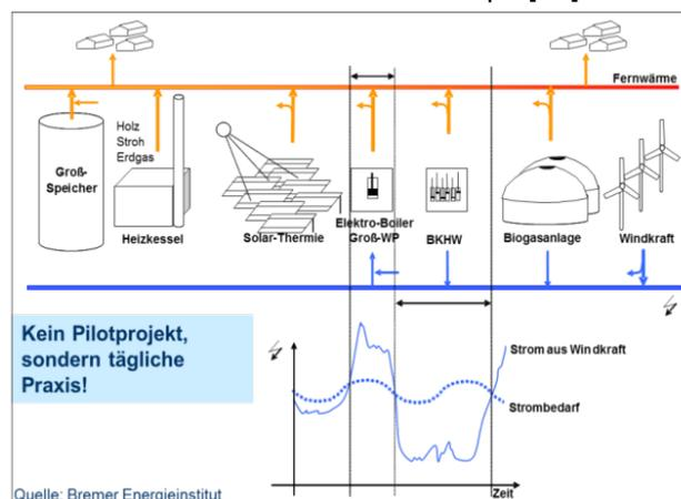
Abbildung 26: Schema eines „smarten“ Fernwärmesystems in Dänemark.
