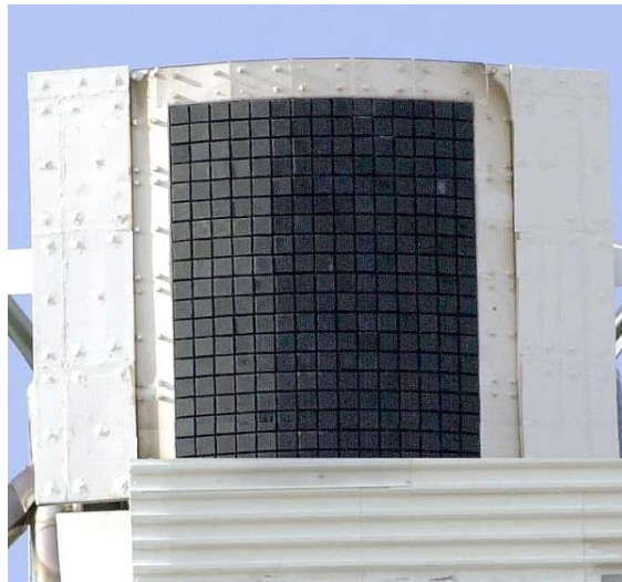
3000 kW SOLAIR PSA 2003
