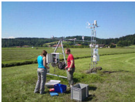
Installation der Eddy-Kovarianz-Station im Fendt-Gebiet innerhalb des "Ammer Einzugsgebietes"
