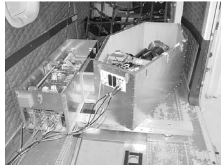
Figure 2.2 View of the calibration unit (left) and the spectrometer optics (right) and thermal boxes on the aircraft back side. Figura 2.2 Vista dell'unità di calibrazione (sinistra), degli spettrometri ottici (destra) e delle scatole termiche, montati nella parte posteriore dell'aereo.
