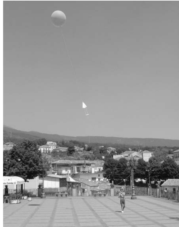
Figure 5.2 Flight train: balloon, parachute, sonde. Figura 5.2 Treno di lancio: Pallone, paracadute, sonda.
