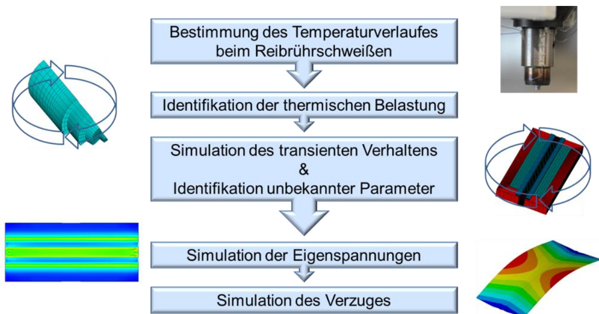
Abbildung 40: Simulationskette zur Vorhersage von Verzug beim Reibrührschweißen ausgehend von experimentell ermittelten Temperaturverläufen am Schweißwerkzeug
