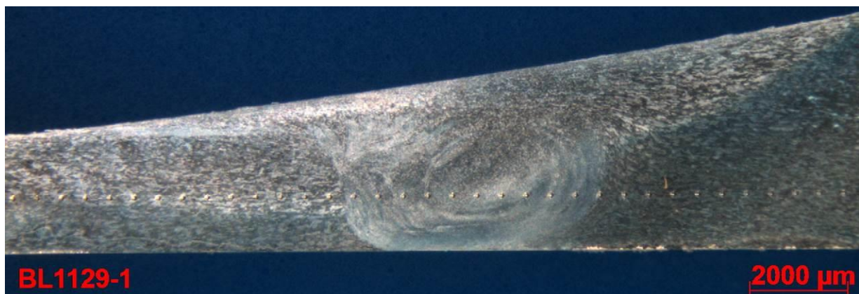
Abbildung 36: Querschliff von FSW 6013-T4 TWB 2,4 zu 5,2
