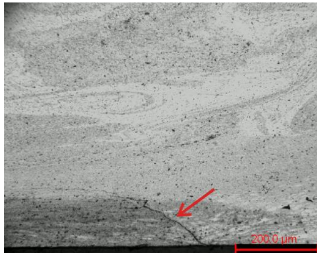
Abbildung 6: LOP im Wurzelbereich der Nahtkonfiguration 3 aus 6013-T4 (BL993)
