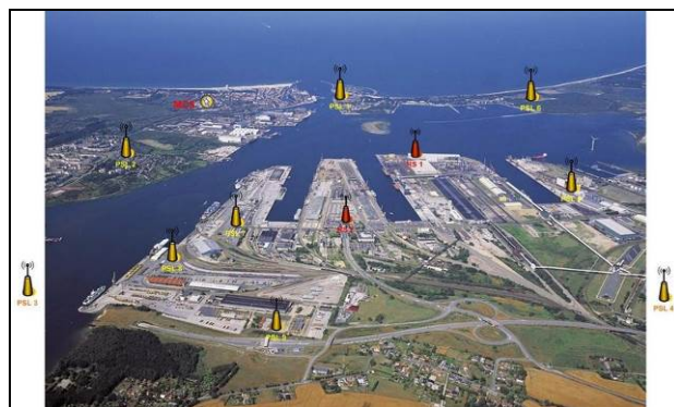
BILD 1. Verteilung der Pseudolites (PSL), der Referenzstationen (RS) und des Monitor Control Segments (MCS) im Bereich des Rostocker Hafens [2]
