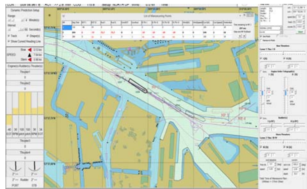
BILD 11. Integrierte Anzeige eines Manöverplans zur Unterstützung der Liegeplatzansteuerung
