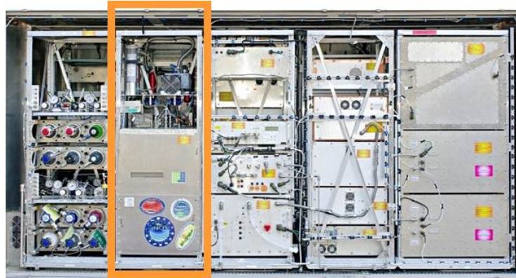
Abbildung 3.2: Offener Luftfrachtcontainer mit CARIBIC Messinstrumenten. Oranger Rahmen: \text{NO}_y Instrument. (Quelle: S. Weber)
