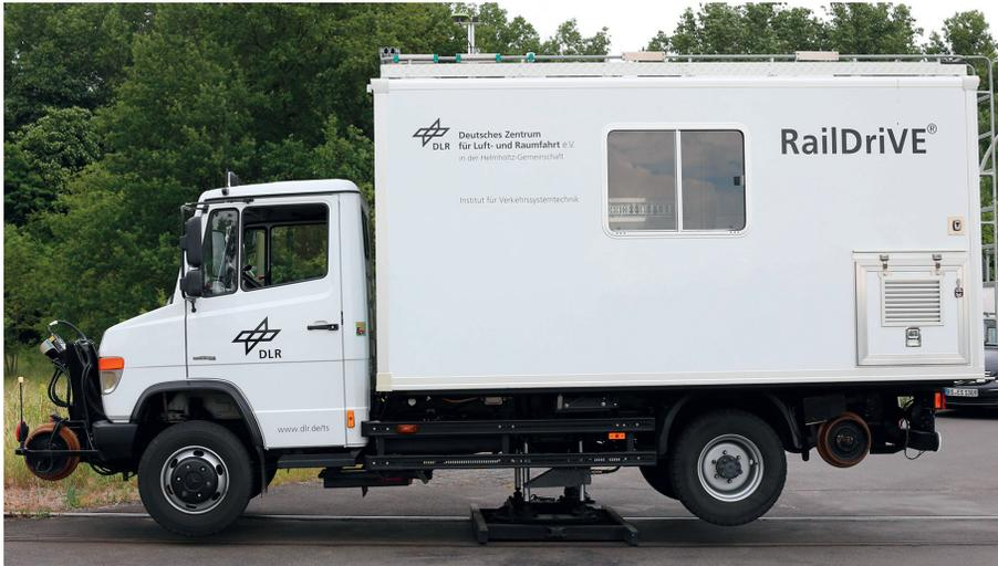
**Abb. 1:** RailDrIVE mit ausgefahrener Aushebe- und Drehvorrichtung zum Drehen und Auf- und Ausgleisen auf einem Bahnübergang
