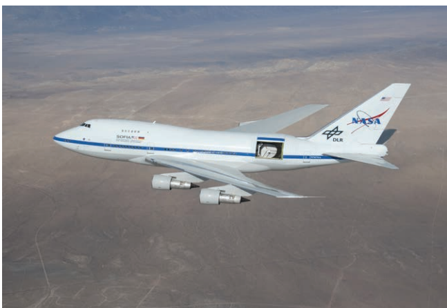
Abbildung 54 SOFIA mit geöffneter Teleskoptür in einer Flughöhe von etwa fünf km über der Mojave-Wüste (Kalifornien) 117
