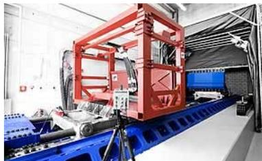
Das Institut für Fahrzeugkonzepte beim Deutschen Zentrum für Luft- und Raumfahrt (DLR) in Stuttgart hat eine neue Crashanlage in Betrieb genommen. Mit dieser können Fahrzeugkomponenten dynamisch getestet werden. Auf einer Strecke von 1,5 Meter wird ein Crasheschlitten mit 1,3 Tonnen Gewicht auf 64 Stundenkilometer beschleunigt, um dann auf die Test-Strukturen zu treffen, erläutert das DLR die Funktion. Rund eineinhalb Jahre sollen Planungs- und Umsetzungsphase gedauert haben.
